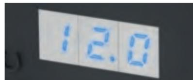
Son afficheur permet de régler simplement les paramètres de connexions/déconnexions (tension, température, alarme, activation des modes)
